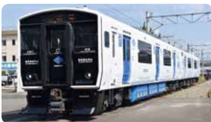
JR九州BEC819系電車 通称「DENCHA(でんちゃ)」 ※「D」UAL 「EN」ERGY 「CHA」RGE TRAINの頭文字
